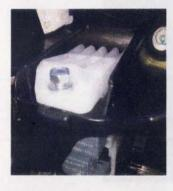
REMOVE THE PLASTIC HOLDER POSITIONED BELOW THE OEM RADIO
