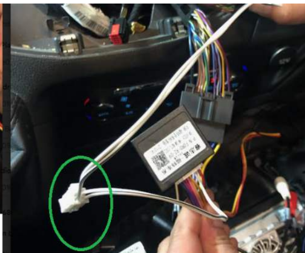
Alleen de witte plug met deze draadjes komt achterin de radio dat is de 8 polige. Die andere is over.
